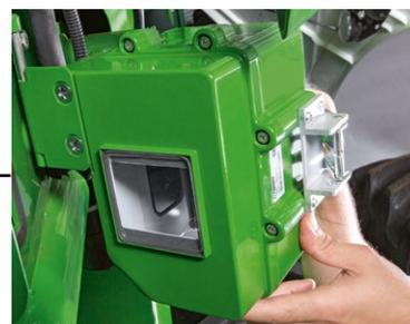
Una imagen en directo de la cámara de alta velocidad ActiveVision™ en el elevador de material de retrilla le permite supervisar y analizar el contenido del material de retrilla en tiempo real.
