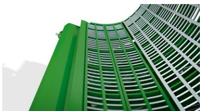
Las dos secciones delanteras del cóncavo de separación son desmontables.
