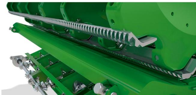
La barra de refuerzo se desacopla en condiciones de trilla normales.
