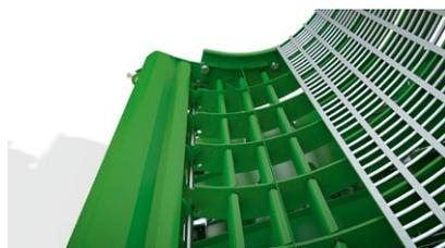
Tras soltar los pernos de bloqueo, puede retirarse la sección del cóncavo.
